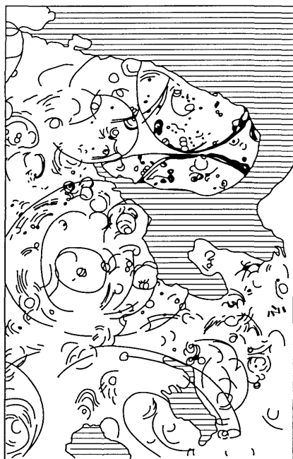
Рис. 5.6. Кольцевые структуры части Балтийского щита по результатам дешифрирования космических снимков
