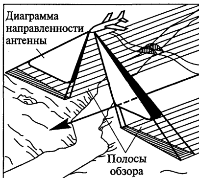
Рис. 2.27. Двусторонняя съемка местности радиолокатором бокового обзора
