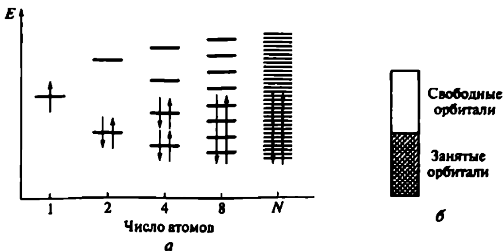
Рис. 9.31. Образование энергетической зоны при увеличении числа химически связанных атомов ( а ); заполнение электронами энергетической зоны вещества с металлическим типом связи ( б )
