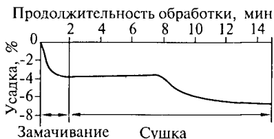
Рис. 2.69. Циклограмма изменения усадки ткани во времени при замачивании и сушке
