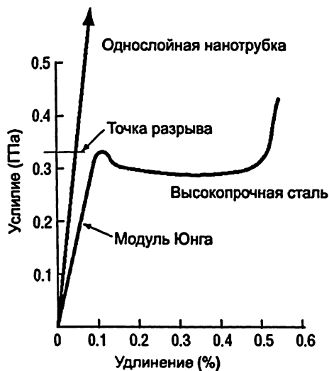
Рис. 38.2. Диаграмма прочности нанотрубок по сравнению с высокопрочной сталью
