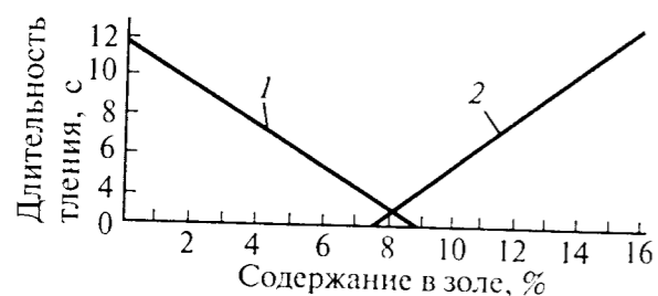
Рис. 3. Зависимость длительности тления табака от содержания в золе хлора (1) и калия (2)
