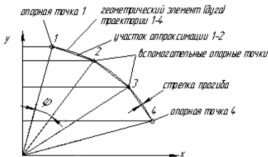
Рис. 8.1. Аппроксимация дуги окружности
