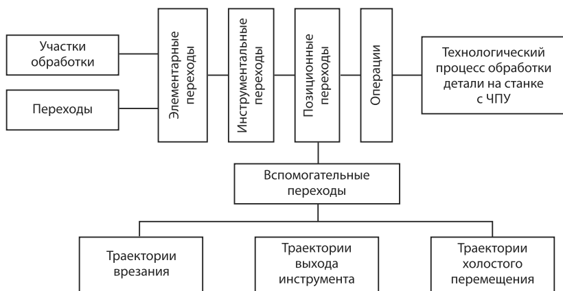
Рис. 7.23. Структура технологического процесса обработки деталей на станке с ЧПУ
