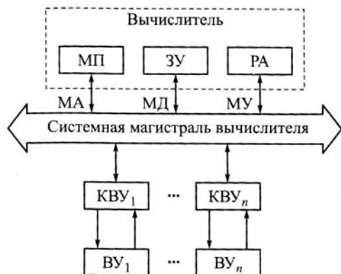
Рис. 2.10. Укрупненная структурная схема программируемого устройства типа ЧПУ (класса CNC)
