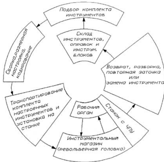
Рис. 3.24. Схема использования режущих инструментов на станках с ЧПУ
