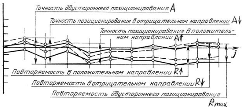
Рис. 11.2. Пример графиков, построенных по результатам измерений точности позиционирования
