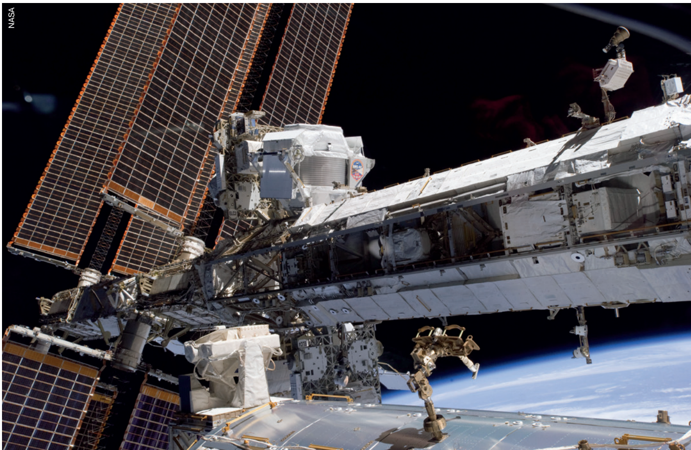
▲ Ферменная конструкция МКС, сфотографированная членами экипажа шаттла Endeavour (миссия STS-134), пристыкованного к станции. Левее и выше центра виден магнитный альфа-спектрометр AMS.
