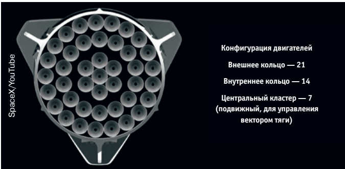
▲ На первой ступени ракеты предполагается установить 42 двигателя Raptor. Успешный вывод полезной нагрузки на околоземную орбиту будет возможен даже при выходе из строя одного или нескольких из них. Суммарная тяга двигателей достигнет 13 тыс. тонн — почти втрое больше, чем у мощнейшей американской ракеты Saturn V, использовавшейся при полетах астронавтов NASA на Луну.
