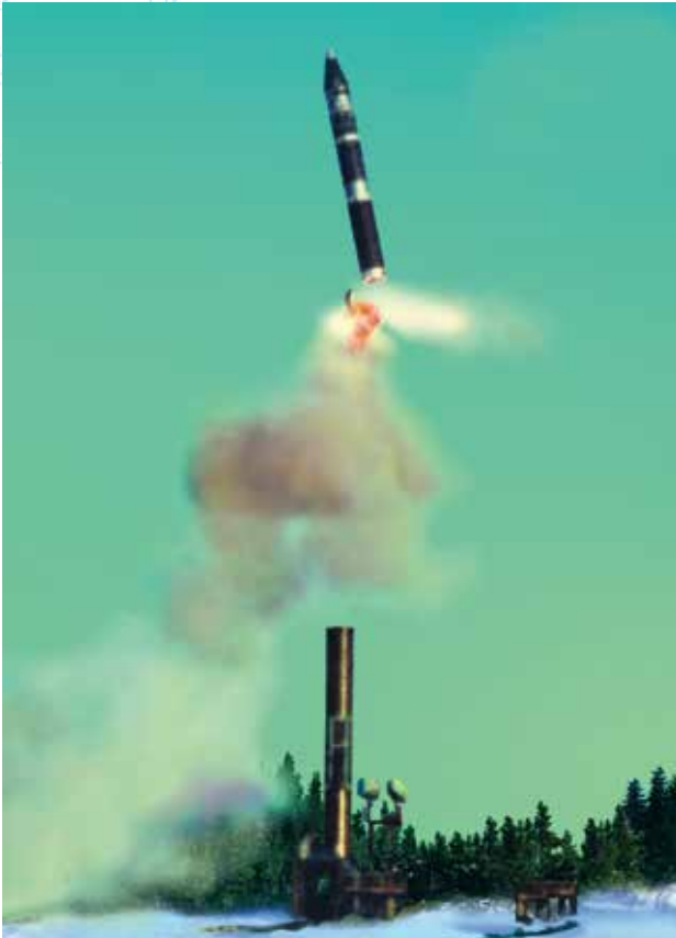
▲ Отличительной особенностью старта ракеты «Молодец» железнодорожного базирования стал принудительный заклон, выполнявшийся для снижения воздействия струи маршевого двигателя на ракетный поезд.
