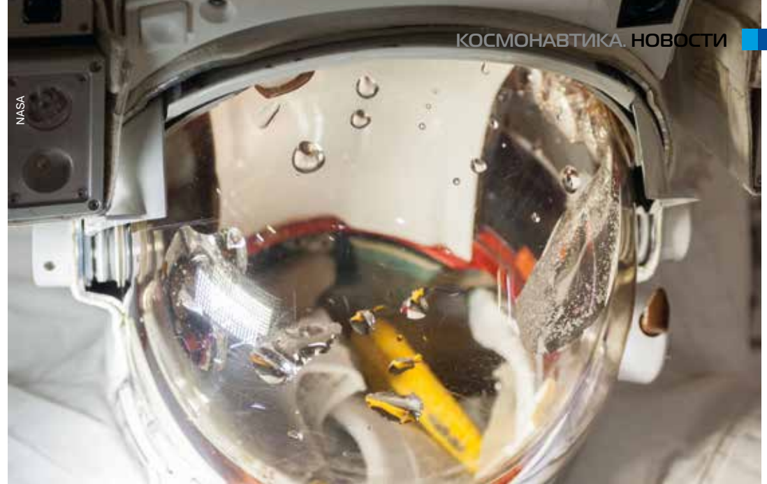
▲ Шлем скафандра EMU, использованного Лукой Пармитано во время выхода в открытый космос 16 июля 2013 г. После возвращения на станцию Пармитано и астронавт NASA Крис Кэссиди (Chris Cassidy) — бортинженеры экспедиции МКС-36 — снова задействовали системы уже снятого скафандра и сразу обнаружили утечку. После такого «эксперимента» специалисты смогли выдать первые рекомендации экипажу по устранению проблемы. Дальнейшие исследования производились уже после возвращения на Землю в лабораториях
