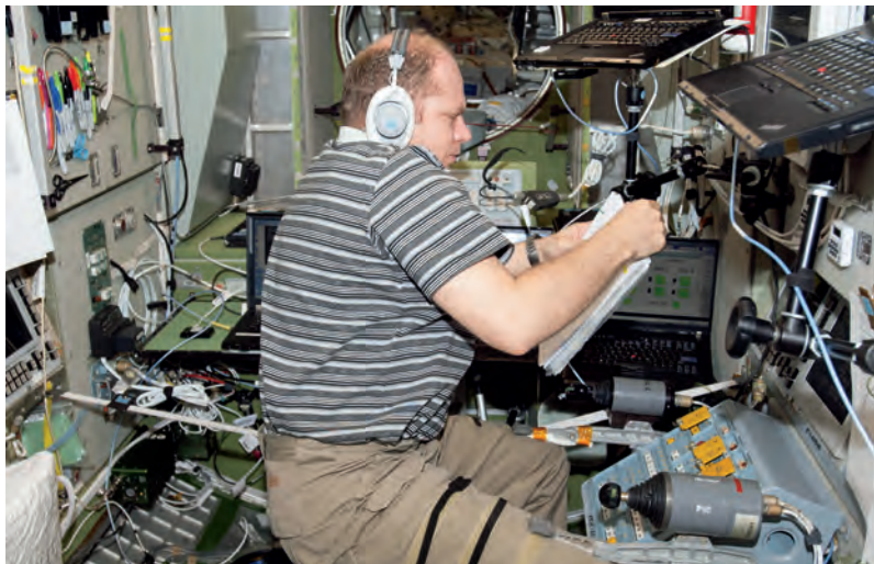
▲ Командир экспедиции МКС-38 российский космонавт Олег Котов, считывает данные ручной системы стыковки ТОРУ в служебном модуле «Звезда» во время операций сближения и стыковки с грузовым кораблем «Прогресс».
