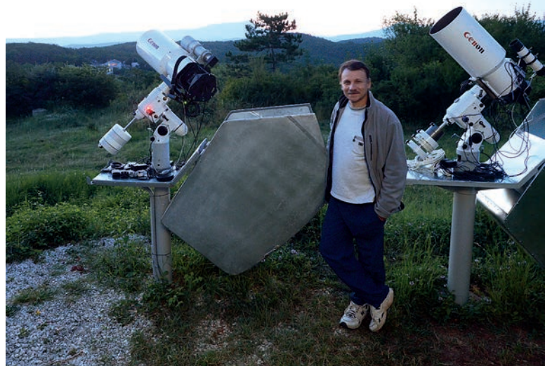
▲ Геннадий Борисов и два его «Генона». Для патрулирования неба используется левый астрограф, оснащенный ПЗС-камерой FLI ML-16803 с матрицей 37х37мм.
