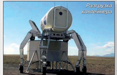
Перемещение контейнеров с помощью зажима
