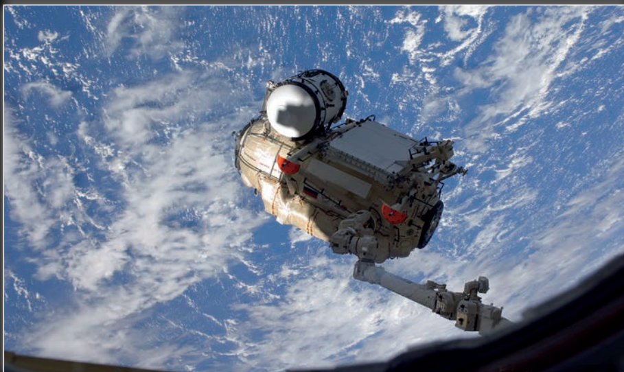
Манипулятор Canadarm2 переносит российский модуль «Рассвет» из грузового отсека шаттла Atlantis к обращенному к Земле стыковочному порту модуля «Заря». 18 мая 2010 г.
