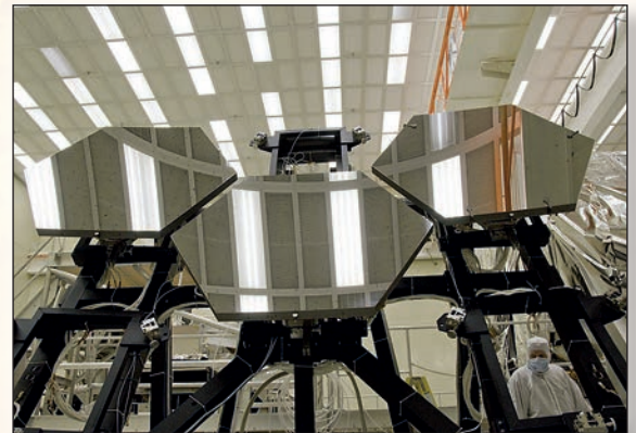
Криогенное тестирование зеркала, производившееся компанией Ball Aerospace в Центре космических полетов им. Маршалла (Marshall Space Flight Center).
