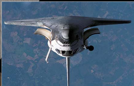
Atlantis перед стыковкой с МКС, во время выполнения маневра, позволяющего оценить состояние его теплозащитного покрытия (10 июня).
