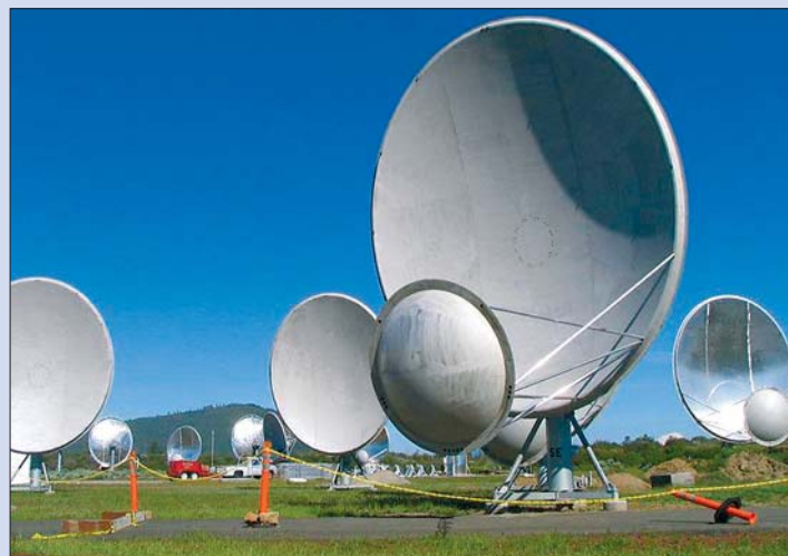
6-метровые антенны строящегося "Однокетарного телескопа" для поиска внеземных цивилизаций.
