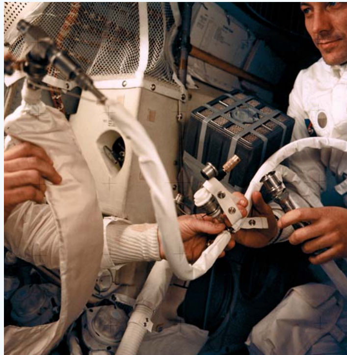
Джон Суиджерт держит в руках изготовленный на борту из подручных средств фильтр \text{CO}_2 — запасные поглотители углекислоты были в командном модуле, но не той формы и размера, поэтому в ход пошли обложки документации, пластиковые мешки, клейкая лента.
