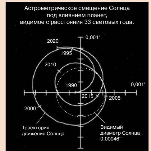
Метод астрометрического измерения. Этот метод основан на обнаружении миниатюрных колебательных движений звезды на небе под действием вращающихся вокруг нее планет. Интерферометр Кеск способен заметить с использованием этого метода планету с массой порядка массы Урана. Подобное воздействие оказывают на Солнце планеты нашей системы.
