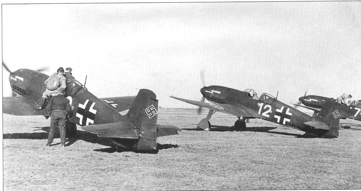
Две пропагандистские фотографии истребителей He-100 D-I в «боевых» подразделениях, сделанные на аэродроме Росток-Мариенех (Rostock-Marienehe) в начале 1940 года. Под фюзеляжем виден дополнительный выдвижной радиатор.
