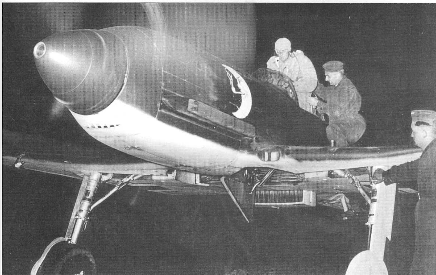
Две фотографии истребителей He 100 D-I из состава фиктивного подразделения почтовых истребителей, лето 1940 года. На выпускных патрубках самолетов установлены пламегасители.
