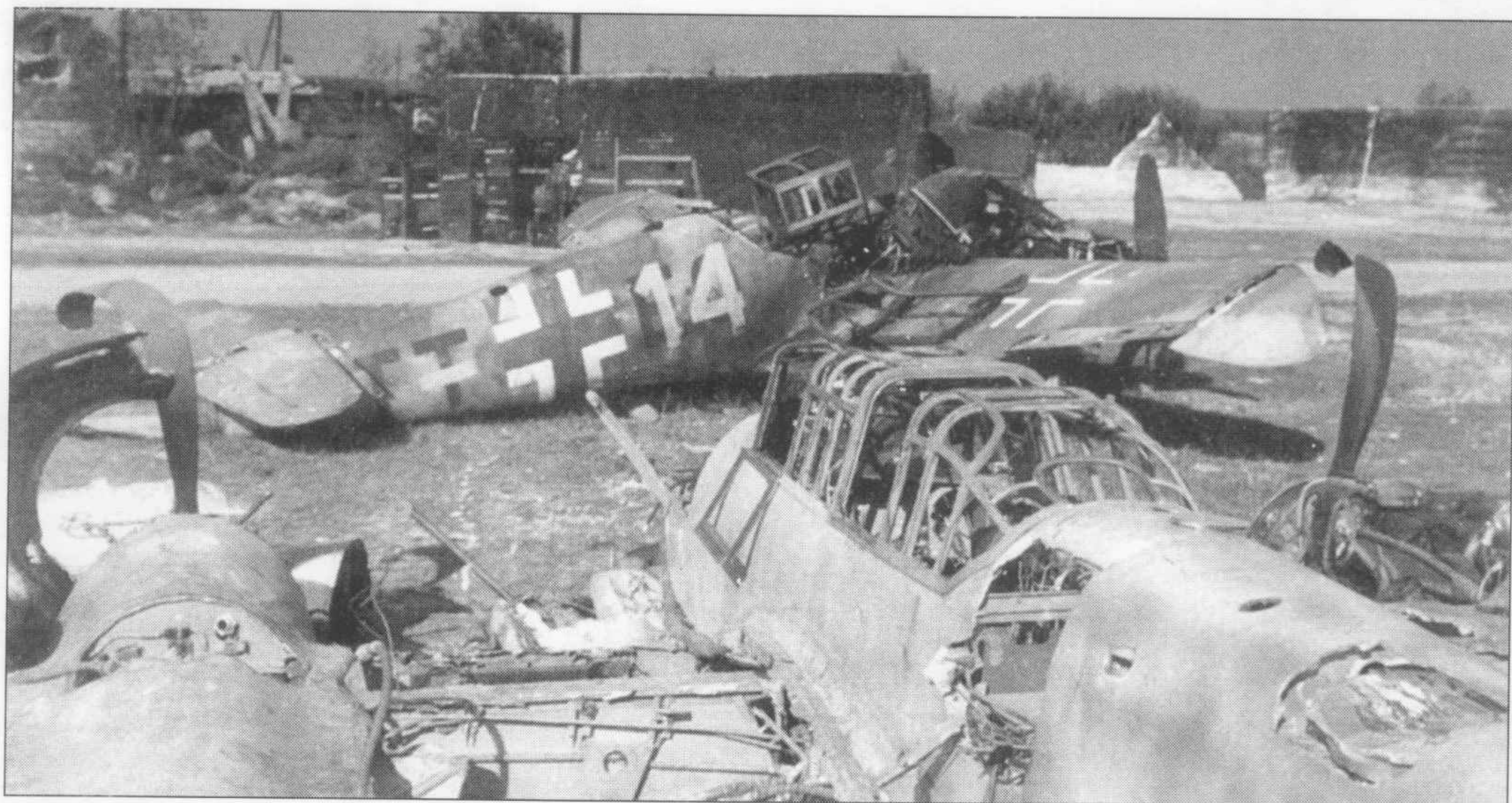
Взорванный Me 109G на аэродроме Жиромон, весна 1945 года. Видно, что это очень старый «Густав», выпущенный еще в 1943 году, о чем свидетельствует горловина в хвостовой части фюзеляжа. Может быть это был самолет, переделанный до стандарта AS? Трудно представить себе, чтобы такой старый самолет уцелел бы другим путем до второй половины 1944 года. Обратите внимание на окраску и обозначения. Верхний камуфляж трехцветный, с использованием RLM 76. Tактический номер «желтая 14» нанесен прямо поверх Stammkennzeichen TT+EO.
