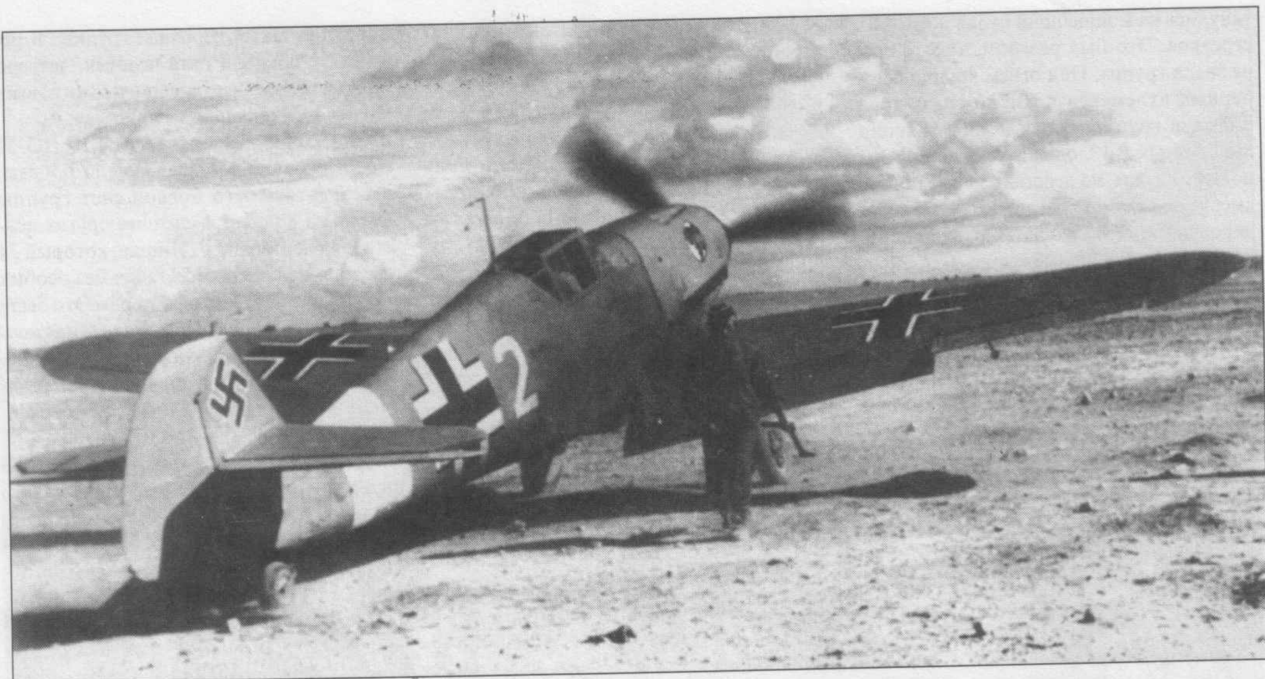
Me 109F-4/троп из I./JG 27, Северная Африка, зима 1941/42 г. Та зима стала последним сезоном, когда немцы в Африке в качестве элементов быстрой идентификации использовали желтые полосы на носу фюзеляжа. Практика показала, что желтый капот почти не контрастирует с пустынным камуфляжем.
