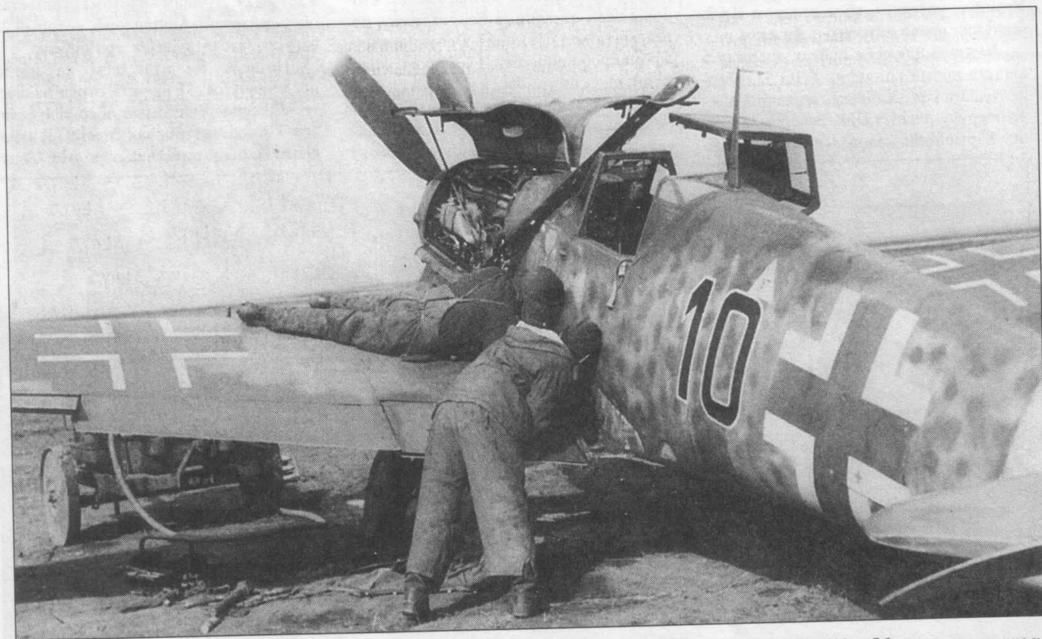
Me 109G-6 во время техосмотра. Машина, вероятно, принадлежала I/JG 52 и применялась зимой 1943/44 г. Обратите внимание на камуфляж, а также на зеркало заднего вида на фонаре, которое в данный период уже практически не использовалось.
