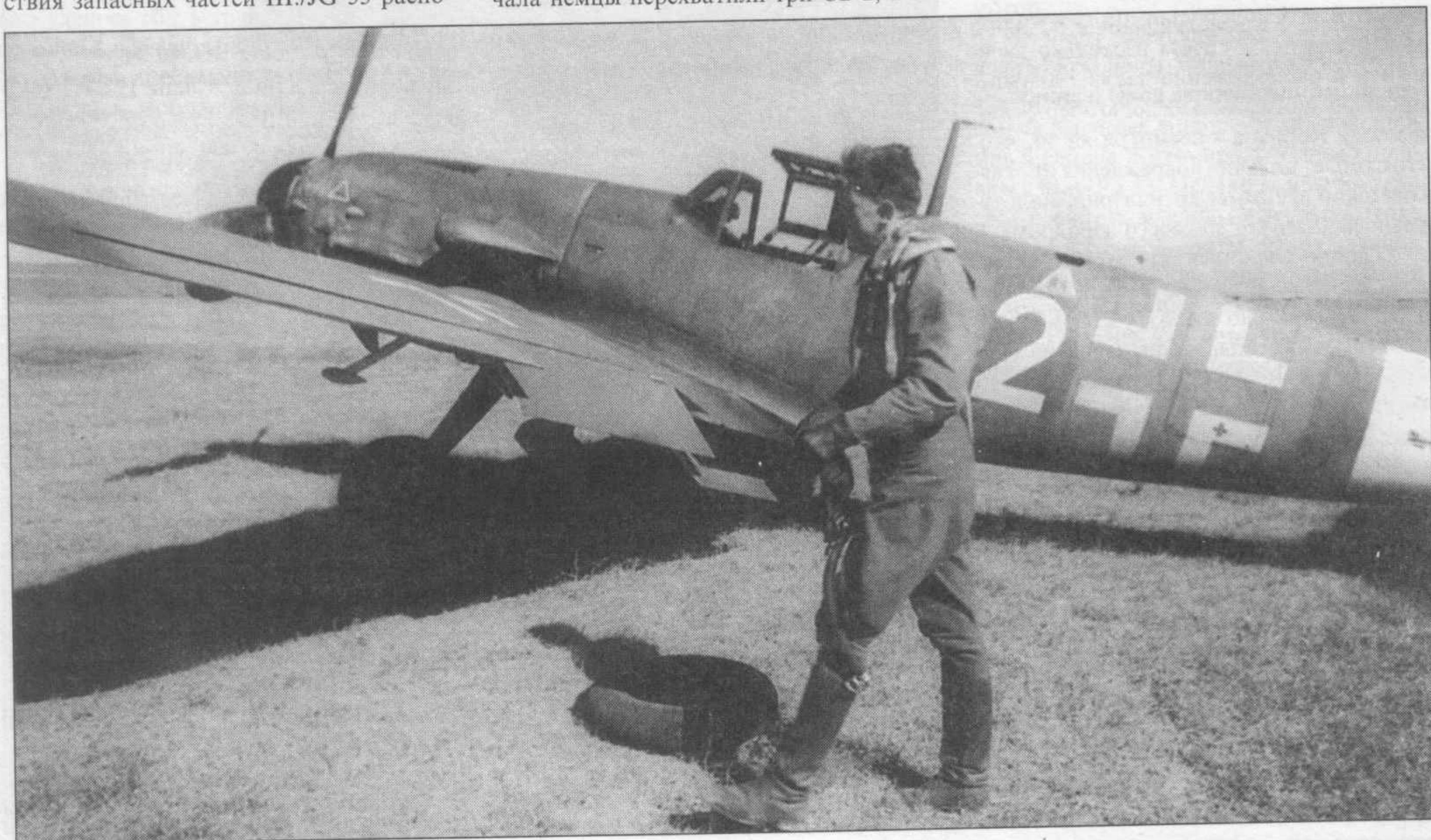
Me 109G-4 одного из истребительных полков люфтваффе, скорее всего JG 52, весна 1943 года. Tактический номер нанесен поверх бортового кода (Stammkennzeichen), окрашенного краской RLM 74. Обратите внимание на треугольник, расположенный рядом с горловиной маслобака, а не под ней, как это обычно практиковалось.
