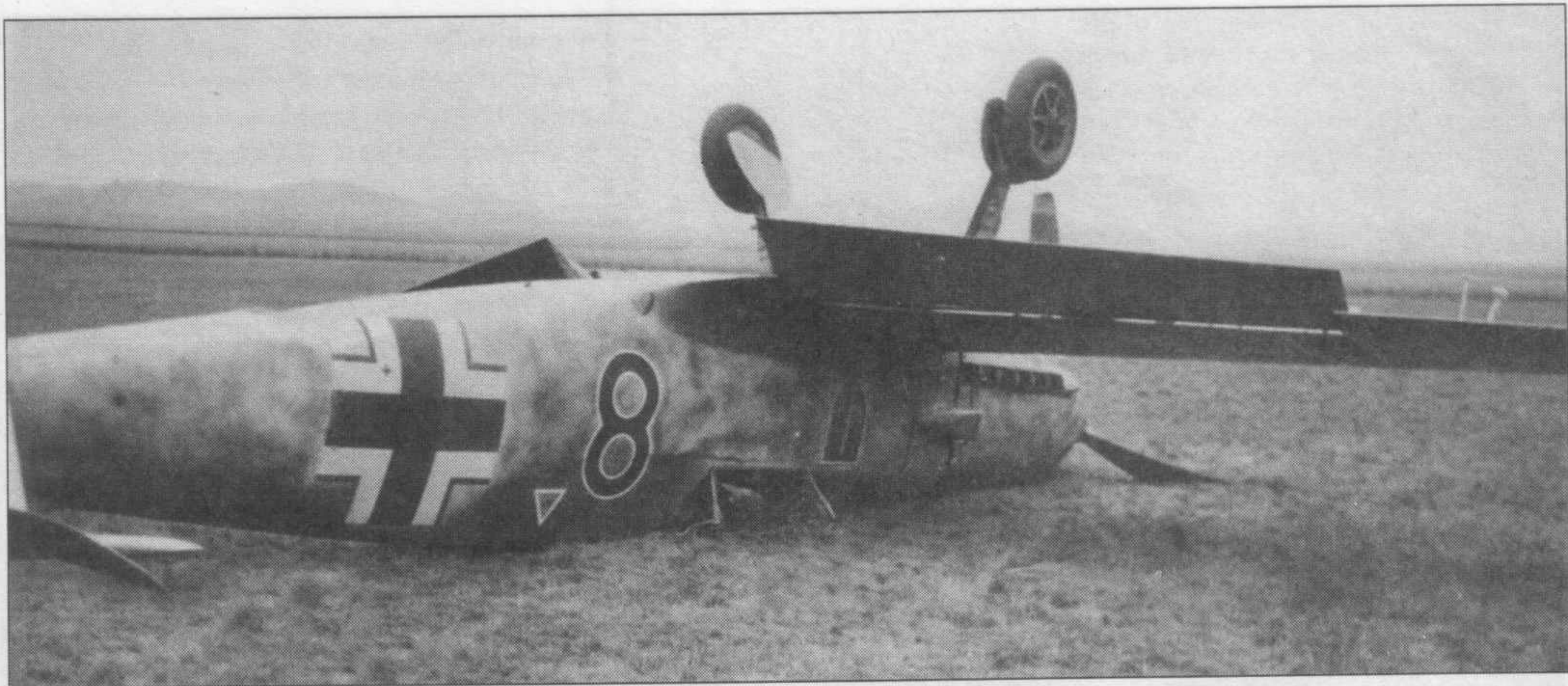
Me 109E из I./JG 52 скапотировал, весна 1941 года. Обратите внимание на то, что кабина пилота полностью разрушена. Отсутствие противокapotажной дуги стало причиной гибели многих пилотов.
