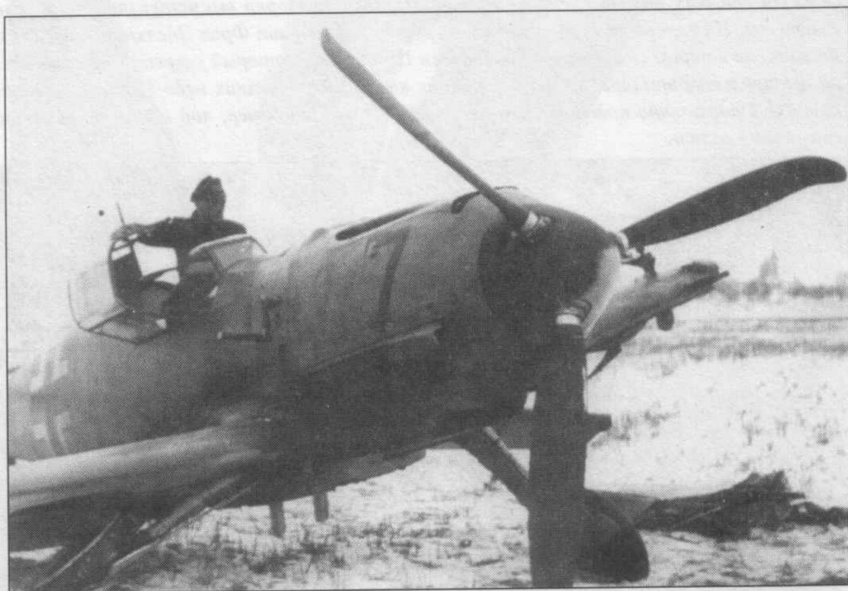
Me 109E-7/B «черная 7» из I./JG 27 после вынужденной посадки в поле. У самолета подломлена правая стойка шасси. Кроме того, у самолета отстрелена почти половина левого крыла, скорее всего в результате прямого попадания зенитного снаряда. Под фюзеляжем виден пилот ETC 50VIII для четырех 50-кг бомб.
