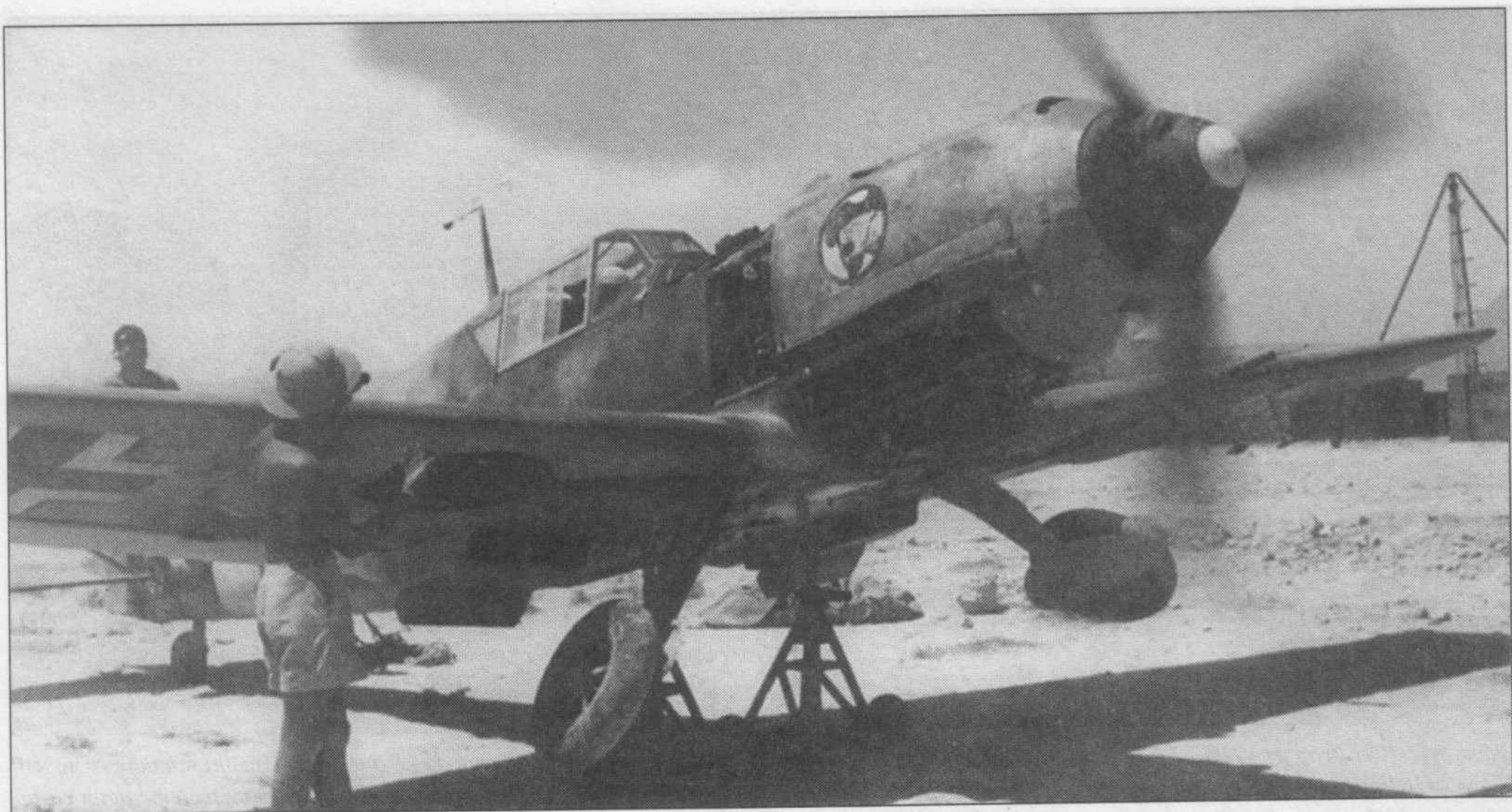
Осмотр механизма уборки шасси на Me 109E из I./JG 27. Шасси убиралось и выпускалось только при работающем двигателе. Отсюда вращающийся винт и две подпорки под фюзеляжем.
