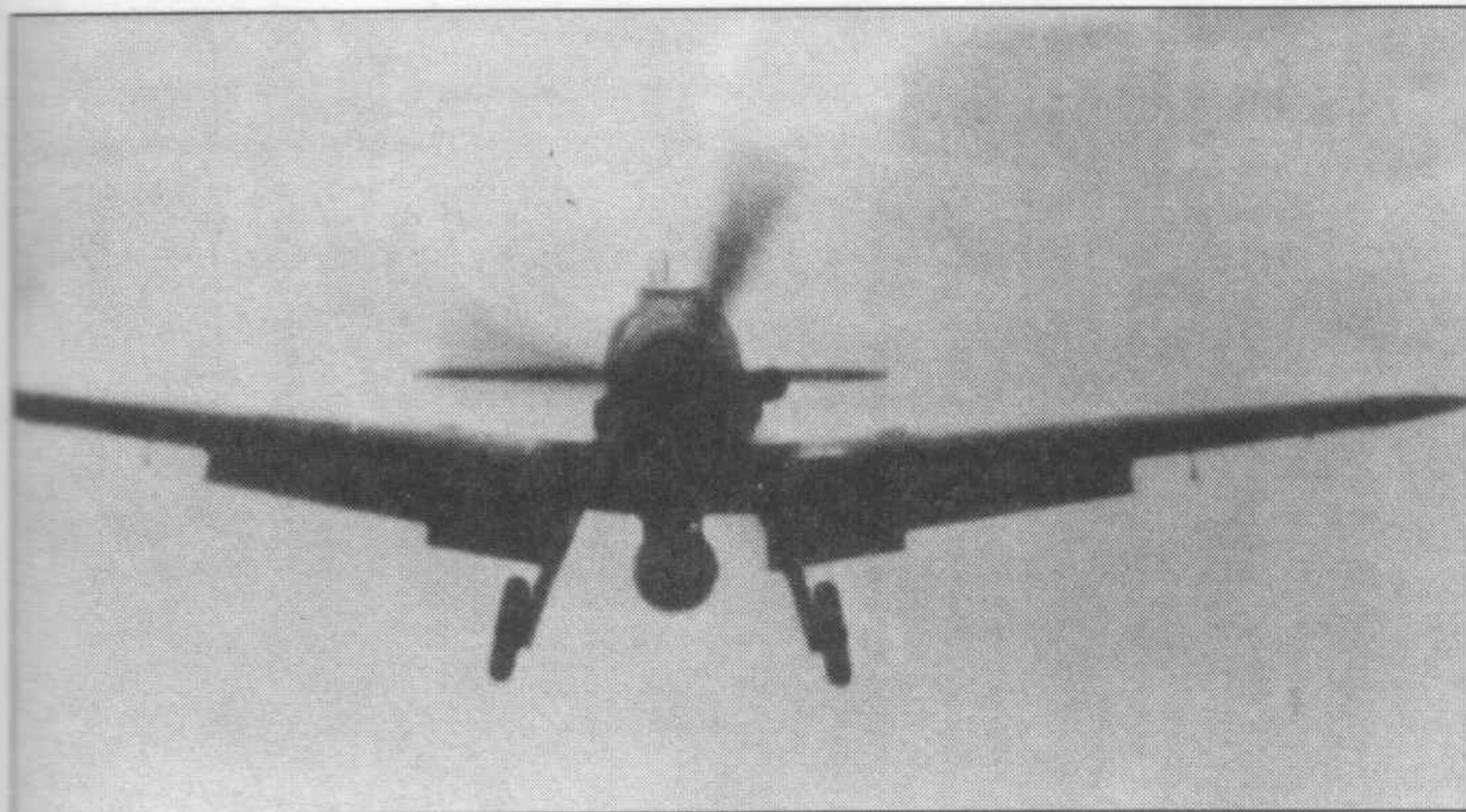
Me 109G-6 заходит на посадку. Видны вытянутые закрылки, в том числе та часть, которая приходится против радиаторов. Взлет и посадка были самым трудным элементом в пилотировании «мессера». Даже немного увеличенная колея у G-10 и K-4 помогала мало.
