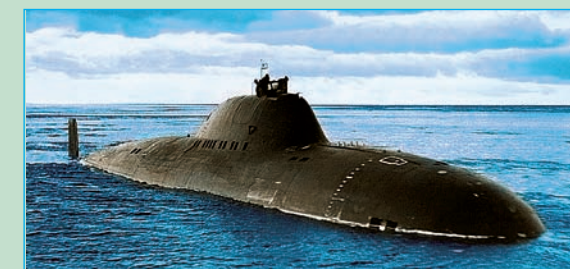
Первая в мире комплексно-автоматизированная атомная подводная лодка с титановым корпусом проекта 705
