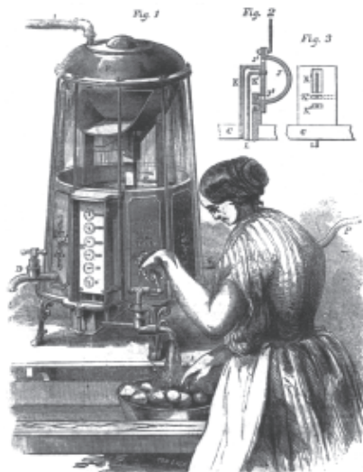
СЧЕТЧИК РАСХОДА ВОДЫ, 1857 г.: устройство нуждается в доработке с целью уменьшения его размеров
