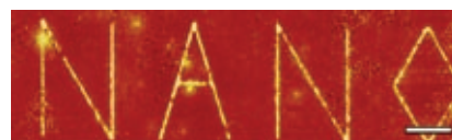
Тонкий слой серебра на очень малых расстояниях действует как суперлинза. Здесь изображение слова NANO получено с помощью сфокусированного пучка ионов ( слева ), оптическим путем без суперлинзы ( в центре ) и оптически, но со слоем серебра толщиной 35 нм ( справа ). Масштабный отрезок имеет длину 2 тыс. нм. Суперлинза дает лучшее разрешение, чем длина волны используемого света в 365 нм
