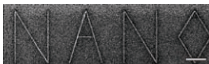
Тонкий слой серебра на очень малых расстояниях действует как суперлинза. Здесь изображение слова NANO получено с помощью сфокусированного пучка ионов ( слева ), оптическим путем без суперлинзы ( в центре ) и оптически, но со слоем серебра толщиной 35 нм ( справа ). Масштабный отрезок имеет длину 2 тыс. нм. Суперлинза дает лучшее разрешение, чем длина волны используемого света в 365 нм
