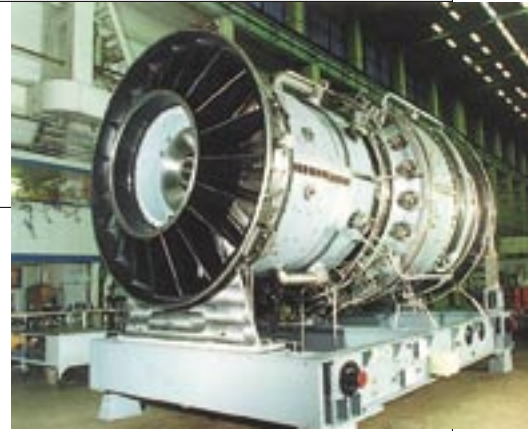
Газотурбинная установка ГТЭ-110
