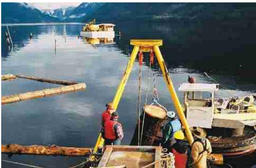
Бревно поднято из воды после того, как его спилили при помощи аппарата с дистанционным управлением *Sawfish*. Аппарат *Sawfish* может погружаться на глубину до 300 м (на следующей странице).
