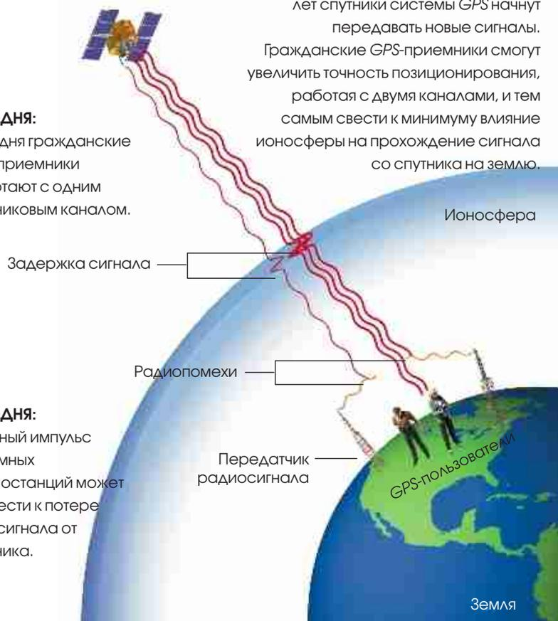
что на приемники попадают сигналы от спутников, прошедшие через разные слои ионосферы. При работе с двумя сигналами мобильный *GPS* способен оценить влияние ионосферы, а данные от фиксированного приемника помогут свести к минимуму остальные погрешности, которые могут составлять от 30 до 50 см.
