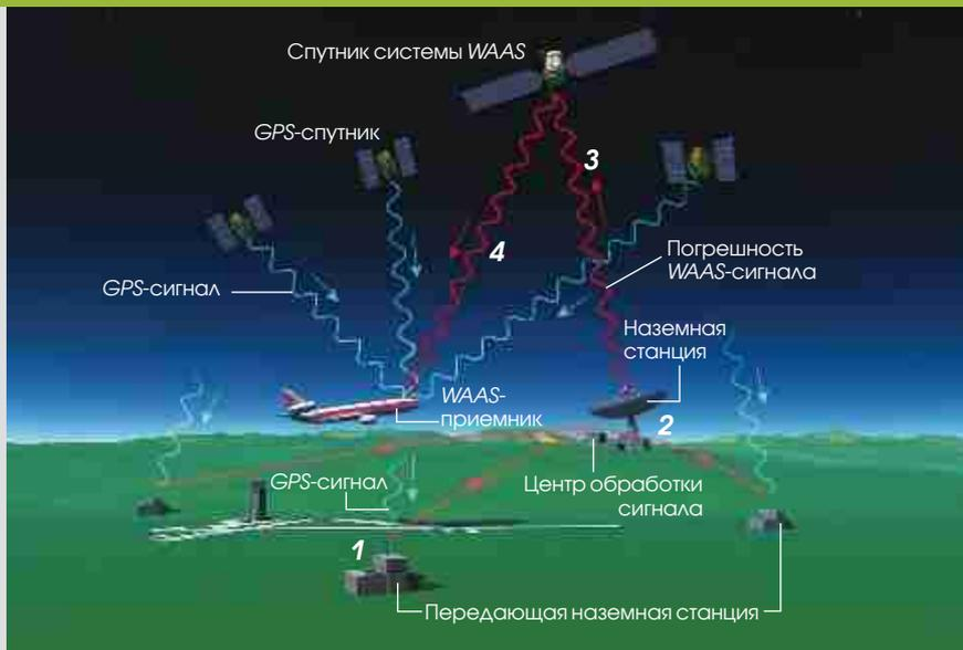
Спутники передают сигналы двух видов. Один из них несет информацию о местонахождении спутника и времени передачи сигнала. Он принимается стационарными наземными станциями, обрабатывается и отправляется на спутник, который передает его всем пользователям системы. Второй сигнал – код, необходимый для определения времени передачи сигнала. Создатели системы называют его псевдослучайным шумом.
