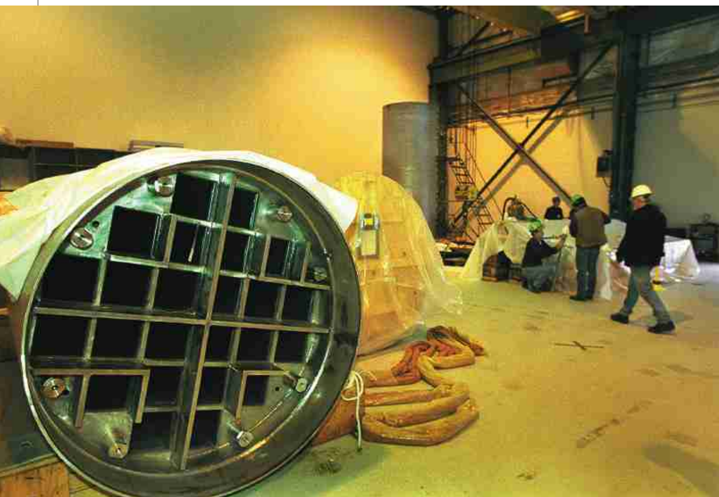
В решетке с 24 отверстиями крепятся сборки радиоактивного топлива длиной 3,6 м (вверху). Получившаяся обойма топливных элементов помещается в стальной кожух со стенками толщиной 6,3 см, а затем в бетонный контейнер высотой 5,7 м и со стенками толщиной 72 см (справа).
