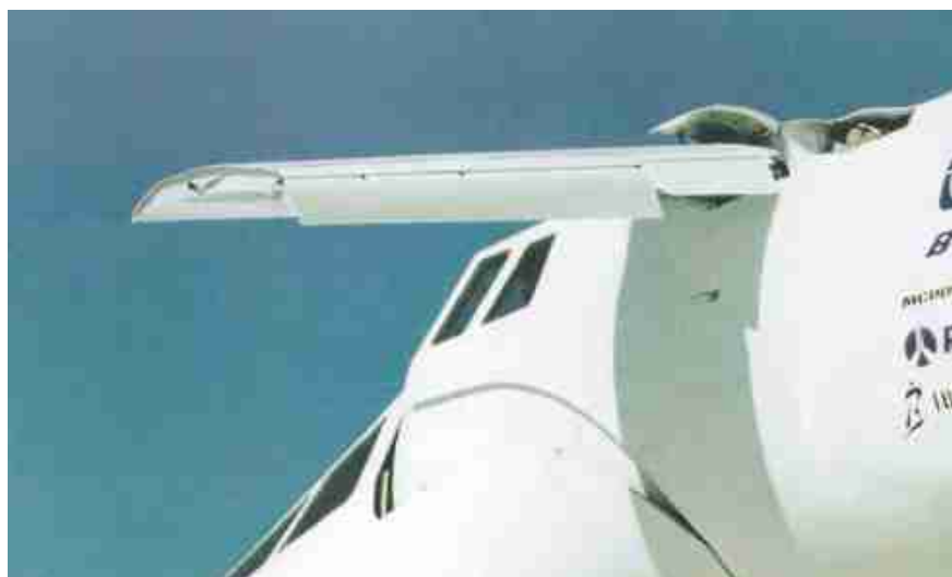
«Заячьи уши» – уникальная находка туполевских конструкторов. Это крылышко позволяет значительно снизить взлетно-посадочную скорость и абсолютно незаметно на сверхзвуке.
