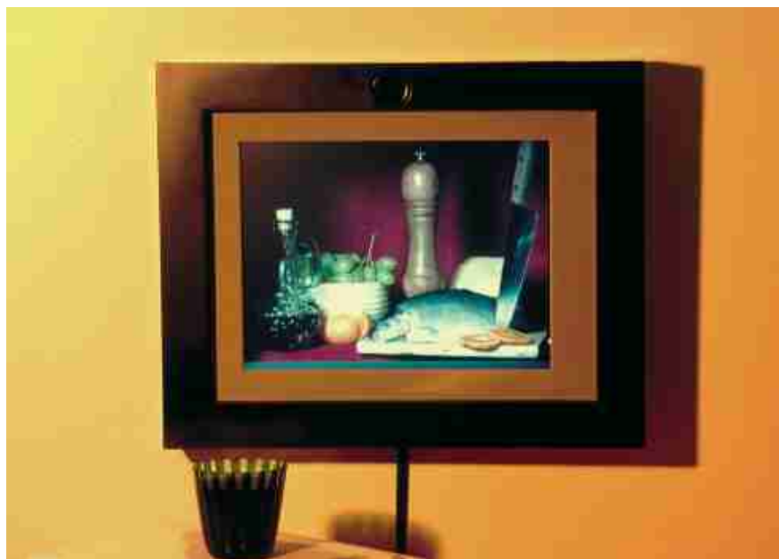
Светочувствительный дисплей, созданный в Колумбийском университете, меняет тени и отражения в соответствии с внешним освещением. Обратите внимание на сдвиг тени при переходе справа налево.
