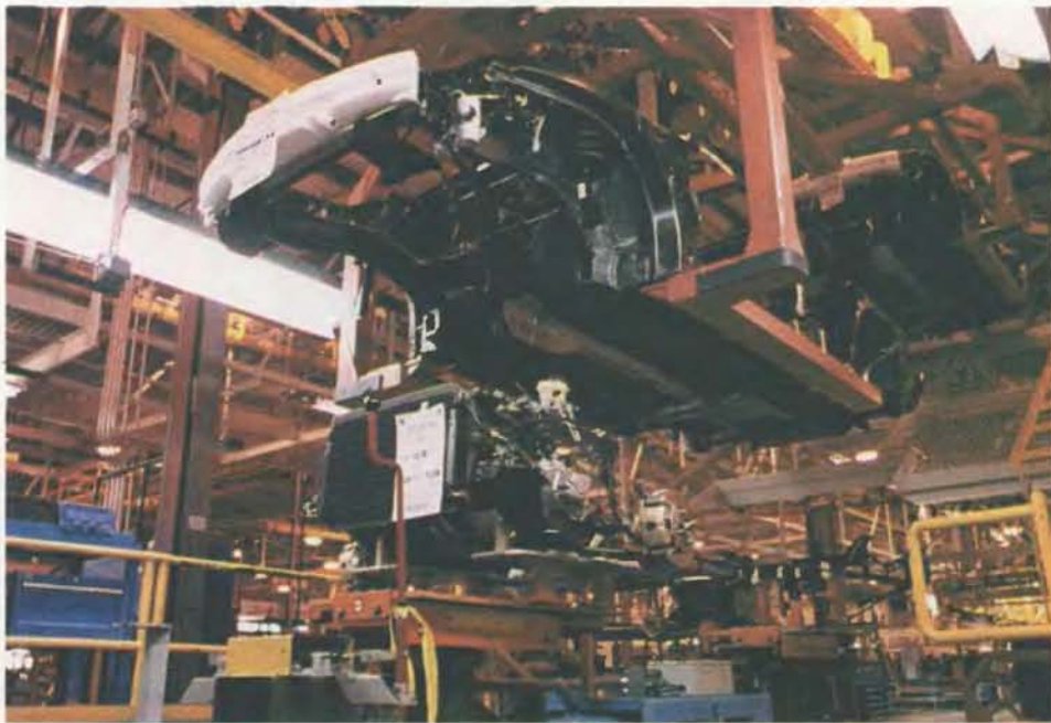
ПРОТОКОЛ АВТОМАТИЗИРОВАННОГО ПРОИЗВОДСТВА используется для управления оборудованием, которое соединяет корпус и шасси автомобилей на заводе «Сатурн» компании General Motors.
