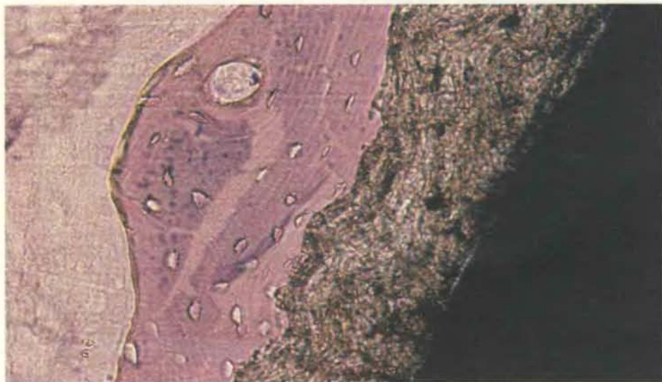
БИОКЕРАМИЧЕСКОЕ ПОКРЫТИЕ из гидроксиапатита (коричневатый слой) способствует росту костной ткани (лиловая область) у поверхности искусственного тазобедренного сустава (черный). Фотография Дж. Колпира.
