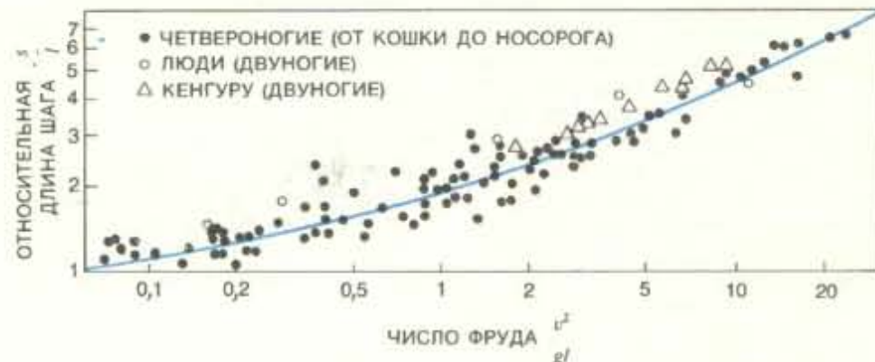
ЧИСЛА ФРУДА для кенгуру, человека и четверногих, таких, как носороги, представлены в зависимости от относительных длин шага. Числа возрастают логарифмически и хорошо видно различие между числами Фруда 0,1 и 20.
