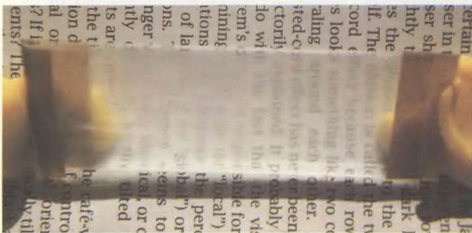
Через область сужения полимерной пленки прочесть текст труднее
