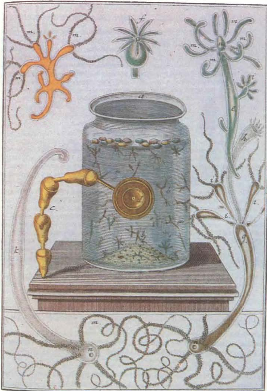
МИКРОСКОП, КОТОРЫМ ПОЛЬЗОВАЛСЯ ТРАМБЛЕ, представлял собой просто линзу, укрепленную на рукоятке с несколькими шарнирами. На рисунке, сделанном Мартином Ф. Ледермюллером около 1762 г., показан также сосуд, в котором Трамбле содержал гидр. Вокруг изображены (по часовой стрелке, начиная с верхнего левого угла) «чудовище» с несколькими головами, сократившаяся и расправившаяся зеленая гидра и особи, скорее всего, вида Hydra oligactis .
