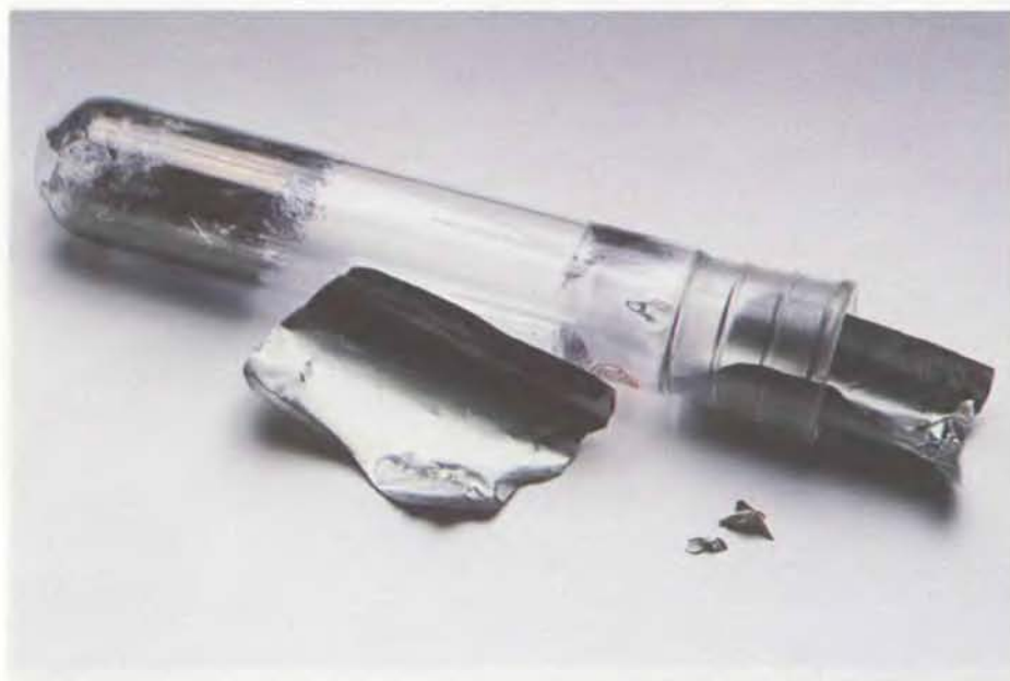
ПОЛИАЦЕТИЛЕНОВАЯ ПЛЕНКА после полимеризации снимается с внутренних стенок стеклянного реактора. Гибкую, как лист бумаги, полимерную пленку допируют, после чего она становится электропроводящей. Такая пленка отражает свет и поэтому имеет металлический блеск.
