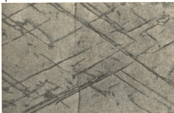
Рис. 13. Винтовые сегменты сверхдислокаций, параллельные \langle 110 \rangle в поликристаллическом \text{Cu}_3\text{Au} , деформированном при 300 °С. Плоскость микрофотографии совпадает с плоскостью \{111\}
