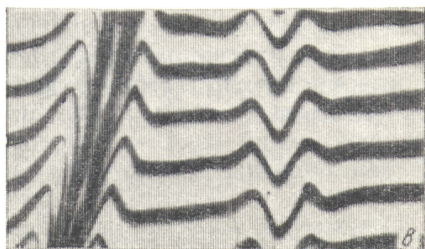
Рис. 12. Сглаживание приблизительно симметричных царапин и образование канавки по границам зерен:
