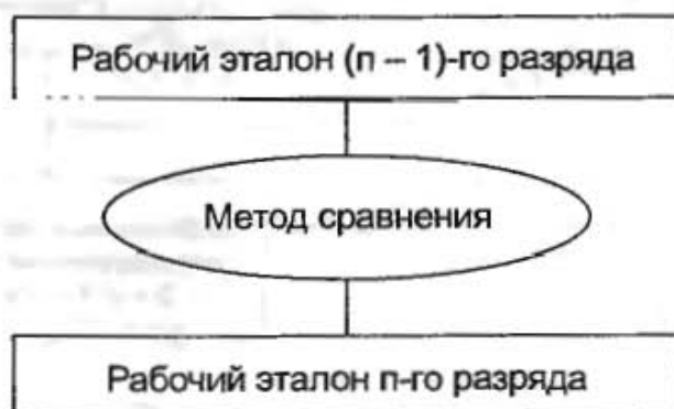
Рис. 95. Обобщенная схема калибровки или поверки рабочих эталонов
