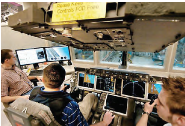
Стенд для испытания БРЭО
