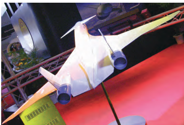
Модель самолета «Соник Круизер» на выставке в Чжухае в 2002 г. Заметно, что угол поперечного V переднего оперения уменьшился почти до 0
