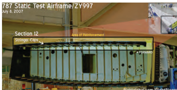
Область необходимого усиления кессона крыла, выявленная по результатам статических испытаний в июле 2007 г.
