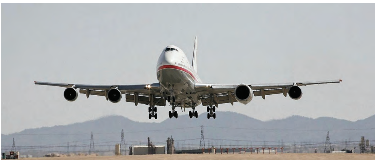
Летающая лаборатория на базе самолета Боинг 747-100 для испытаний ТРДД GEnx
