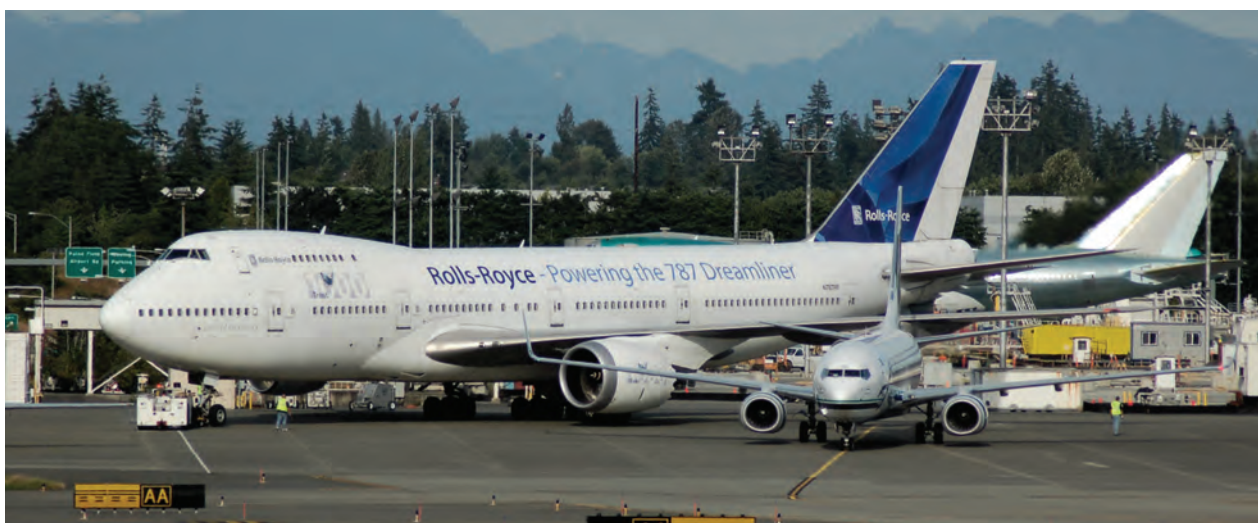
Летающая лаборатория на базе самолета Боинг 747-200 для испытаний ТРДД «Трент» 1000
