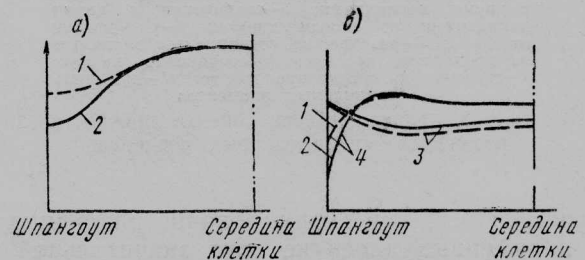
а—кольцевые напряжения; б—продольные изгибающие напряжения 1—клепаная; 2—клееная; 3—над стрингером; 4—между стрингерами
