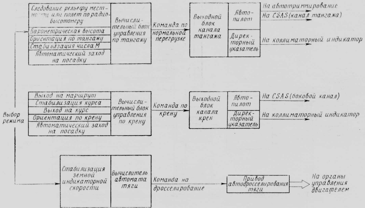
Рис. 9. Вычислительные блоки системы AFDS
