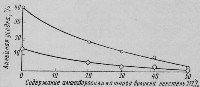
Рис. 8. Зависимость изотермической усадки материала FRCI от содержания алюмоборосиликатного волокна некстель 312 ( \rho = 190 \text{ кг/м}^3 )
