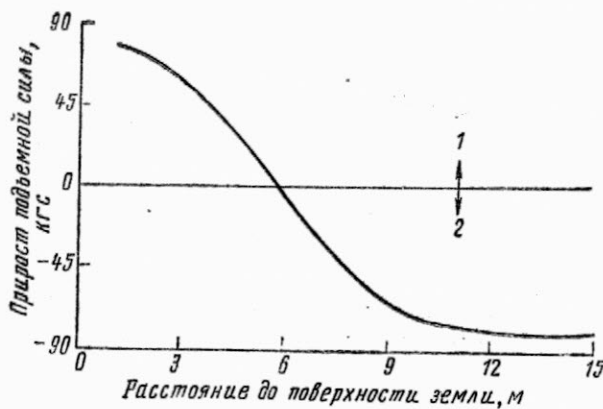
Рис. 11. Изменение прироста подъемной силы несущего винта в зависимости от расстояния до поверхности земли (от колес вертолета) и определение оптимальной крутки лопасти на режиме висения
