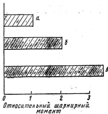
а—лопасть с малой круткой, без кривизны профиля; б—лопасть с кривизной и малой круткой; в—лопасть с кривизной и большой круткой
