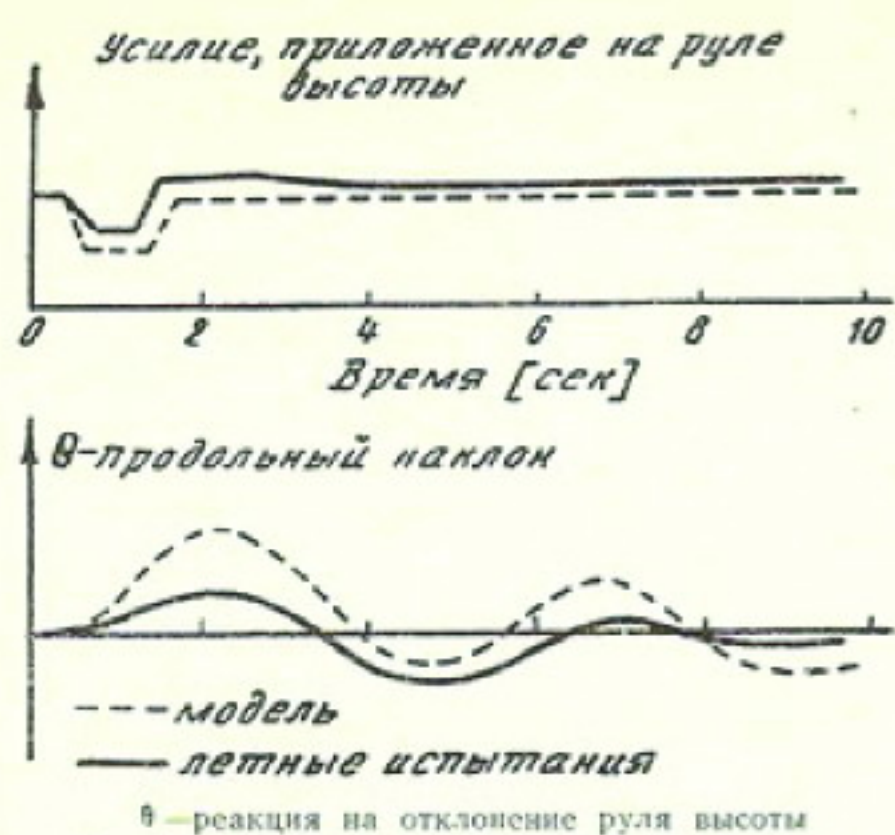
Фиг. 12. Сравнение результатов летных испытаний и результатов, полученных при испытаниях на тележке (фиг. 11) модели вертикально взлетающего самолета Вертол VZ-2 в масштабе 1/5,2
