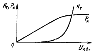
Рис. 8.5. Зависимость K_{\text{г}} и P_{\text{н}} от амплитуды входного напряжения U_{\text{мвх}}
