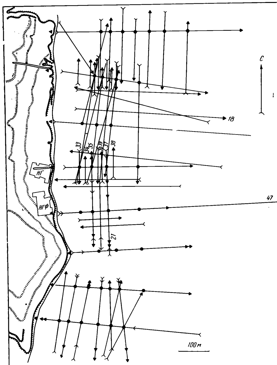
Рис. 2. Схема расположения створов и профилей, пройденных прибором ЗГЛ-1 на ольвийской акватории
