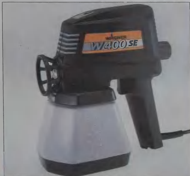
Пистолет-распылитель нового поколения, оснащенный двигателем с качающимся якорем; насос расположен в головной части корпуса, регулирующий винт – с задней стороны рукоятки; инструмент снабжен прозрачной емкостью для краски.
