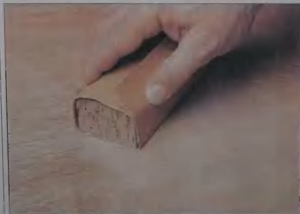
После того как грунтовка высохнет, поверхность дерева тщательно шлифуют наждачной бумагой с самым тонким абразивным покрытием (зернистость 240).
