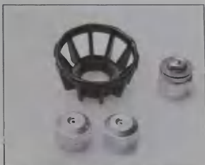
Сопла, образующие круглую, плоскую или игольчатую струю, устанавливаются в несколько приемов.
