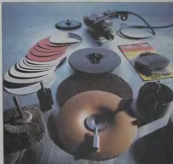
Плоские и цилиндрической формы щетки, тарельчатые круги, на которые насаживают самоклеящиеся пластинчатые шлифовальные диски, закрепляют в патроне электродрели. С их помощью удаляют ржавчину с металлической поверхности, очищают ее и доводят до блеска.
