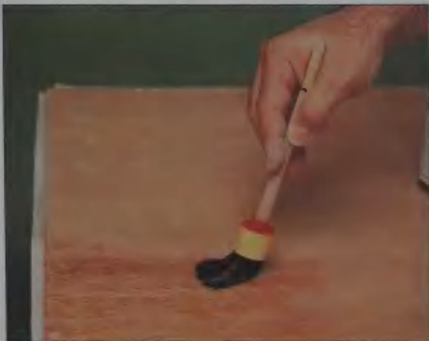
Грунтовку наносят толстым слоем и после высыхания шлифуют. Наждачную пыль следует удалять очень тщательно.
