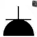
Розетка двухпо- люсная с защит- ным контактом, IP44-IP23
