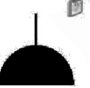
Розетка двух- полюсная со степенью защиты IP44-IP23
