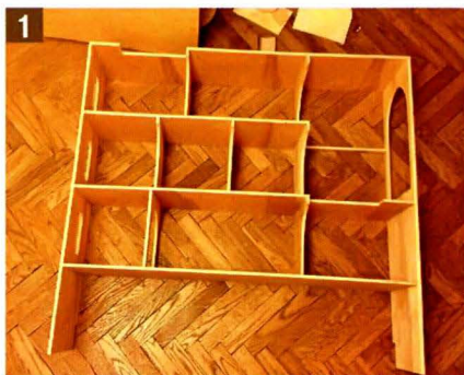
Остов домика в сборе. Детали подогнаны и соединены саморезами.
