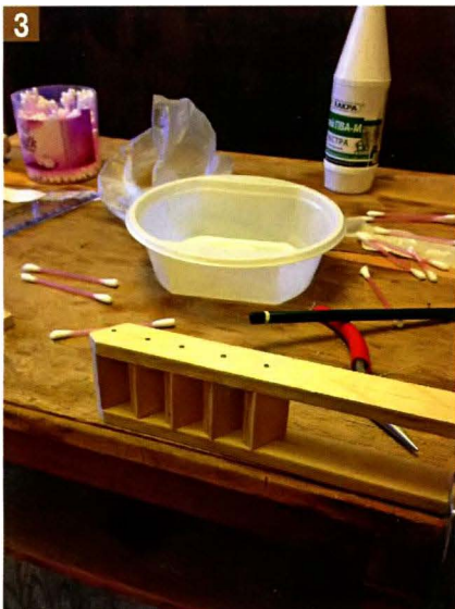
3 Момент сборки межэтажной лестницы. Нижняя тетива зафиксирована на верстаке струбциной.
