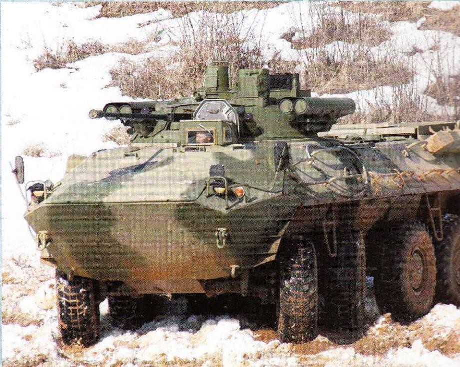
**Комплекс вооружения «Бахчи-У» эффективно поражает как наземные, так и воздушные цели, а из 100-мм орудия можно вести огонь не только прямой наводкой, но и из закрытых огневых позиций. Неуправляемым 100-мм осколочно-фугасным снарядом можно поражать живую силу, здания и механизированные средства противника на расстоянии до 7 км, а танковой управляемой ракетой «Аркан» – до 5,5 км. 30-мм автоматическая пушка ведет огонь на 4 км осколочно-фугасным и на 2,5 км – бронебойно-подкалиберным снарядом.**
