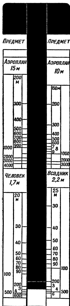
Рис. 40. Устройство выдвигаемого дальномера.
