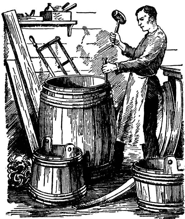
Рис. 110. Тугое обхватывание бочки обручами достигается надвиганием их на широкую часть.
