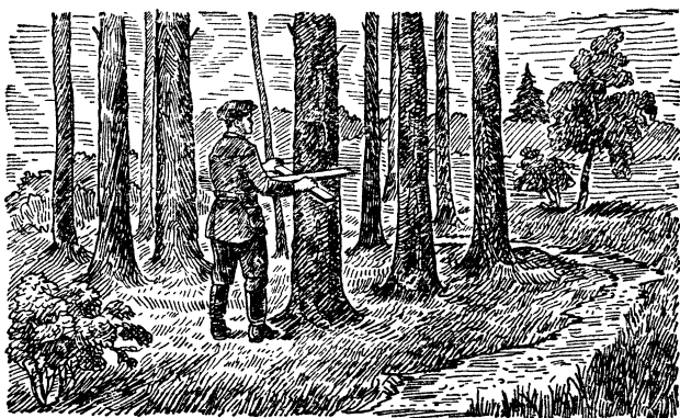
Рис. 19. Измерение диаметра дерева мерной вилкой.
