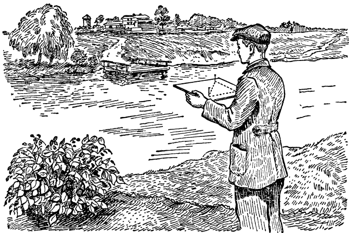
Рис. 25. Измерение ширины реки булавочным прибором.
