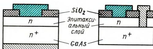
Рис. 3.47. Варианты структур диодов Шотки с двухслойной базой
