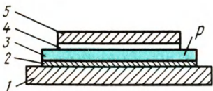
рис. 3.42. Структура селеновой выпрямительной пластины:
