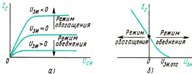
Рис. 6.12. Выходные статические характеристики (а) и статические характеристики передачи (б) МДП-транзистора со встроенным p -каналом
