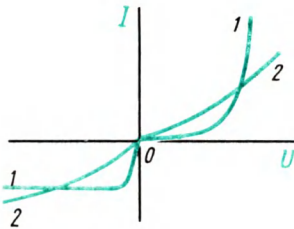
Рис. 3.13. Зависимости от напряжения составляющих тока через диод, вызванных только процессами инжекции и экстракции носителей заряда через p - n -переход (1) и процессами рекомбинации и генерации носителей заряда в p - n -переходе (2)
