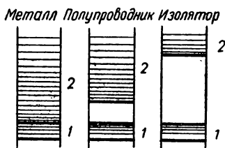
Рис. 96. Энергетическая структура спектра электронов металла, полупроводника и изолятора.
